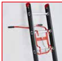
Uchwyt dystansowy Większa stabilność i bezpieczeństwo dzięki uzyskaniu dystansu między drabiną a ścianą. Niezastąpiony np. podczas czyszczenia rynien. Pasuje do wszystkich drabin Altrex.
